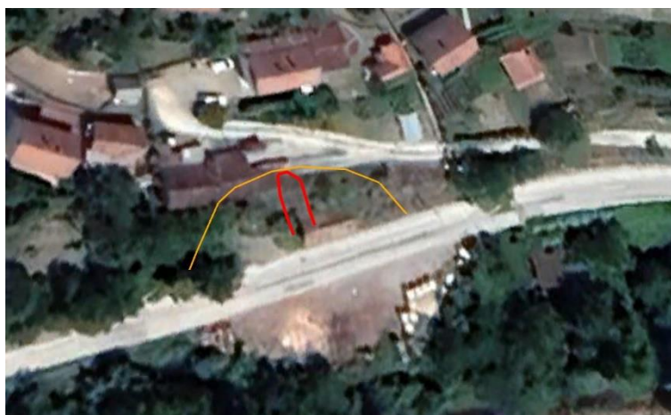
Слика 18 - снимак објекта, штале и гараже у односу на клизитише које је настало и потенцијалну зону клизања
